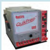
换固液色谱柱，使制备量从每年的毫克级增加到吨级。根据公司介绍，不会发生柱上吸收或降解。质量平衡是CCC/CPC的标准。通常可以节省50-80%的溶剂。标准两相溶剂、离子液体、液体手征选择剂和离子交换剂均可以使用。根据公司介绍，可以在不造成污染的情况下，将可毒化色谱柱的原材料注入到标准色谱柱中。
